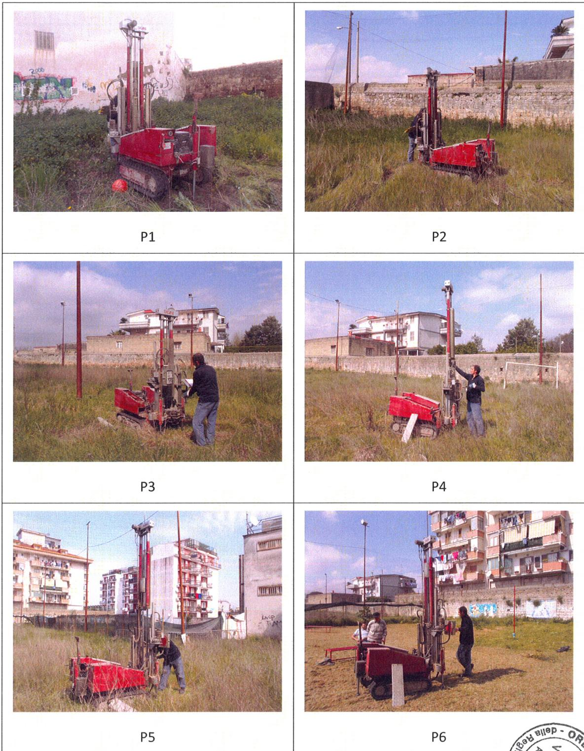
Figura 9 – Immagini relative alle singole prove penetrometriche realizzate.
