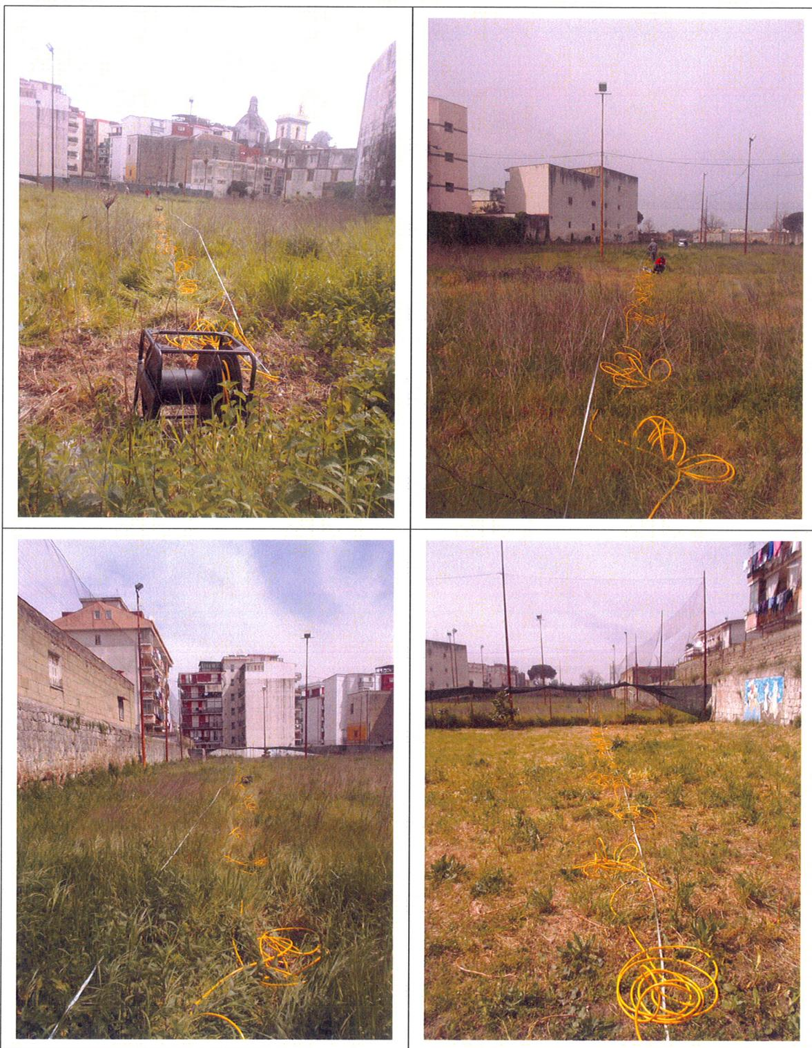
Figura 17 - Stendimento multielettrodo in configurazione di acquisizione Wenner-Schlumberger effettuato, con spaziatura 2m e lunghezza dello stesso di 94 m.
