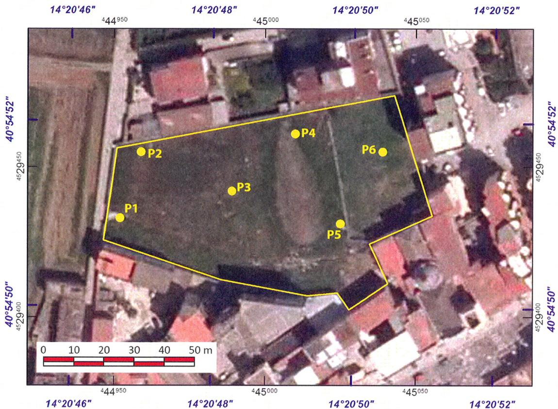
Figura 8 – Localizzazione delle prove penetrometriche dinamiche tipo DPSH.
