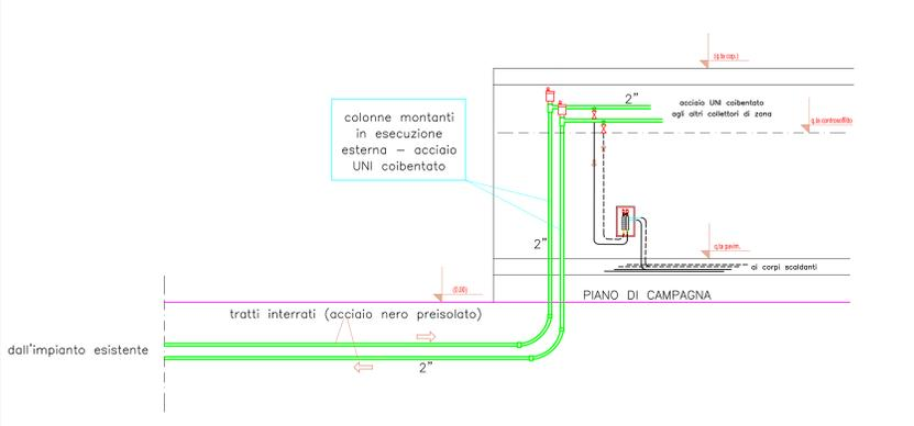
Schema esecutivo di principio per il collegamento ai collettori di zona
